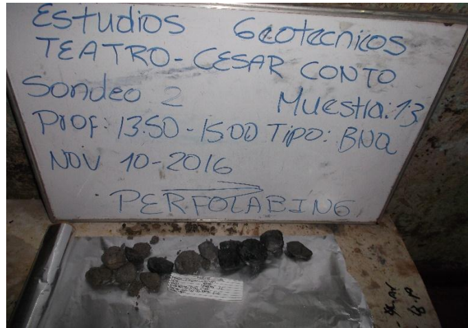
Fotografía 2 Muestra obtenida con corona de diamante NQ
