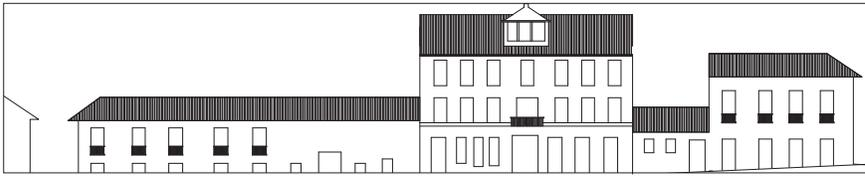
Ilustración 12. Hipótesis de la fachada del Coliseo. Dibujo realizado sobre el grabado. Se presenta un edificio con ventanas simétricamente dispuestas y con las proporciones verticales, recurrentemente utilizadas en la época de construcción. No se incorporan elementos ornamentales. Arriba se mantiene el mirador.
