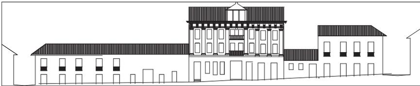
Ilustración 13. Hipótesis de la fachada del Teatro Maldonado. Dibujo realizado sobre el grabado. Se presenta un edificio con ventanas simétricamente dispuestas y con las proporciones verticales, recurrentemente utilizadas en la época de construcción. Se incorporan las ocho columnas y el arquitrabe de remate que oculta el alero. Arriba se mantiene el mirador al que se le incluyen cornisas.
